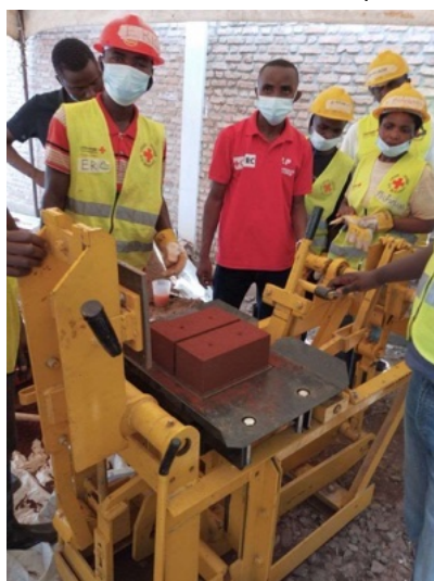
Arrivée de l'équipe de la RDC pour la formation complémentaire en BTC : tamisage, dosage, présentation et entretien de la presse Terstaram ; fabrication, manipulation, cure, séchage
