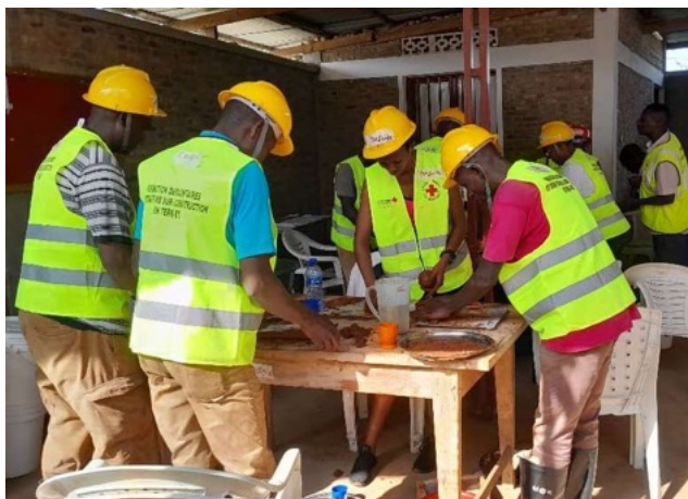
Test du cigare : tamisage de la terre, préparation et exécution. Résultats
