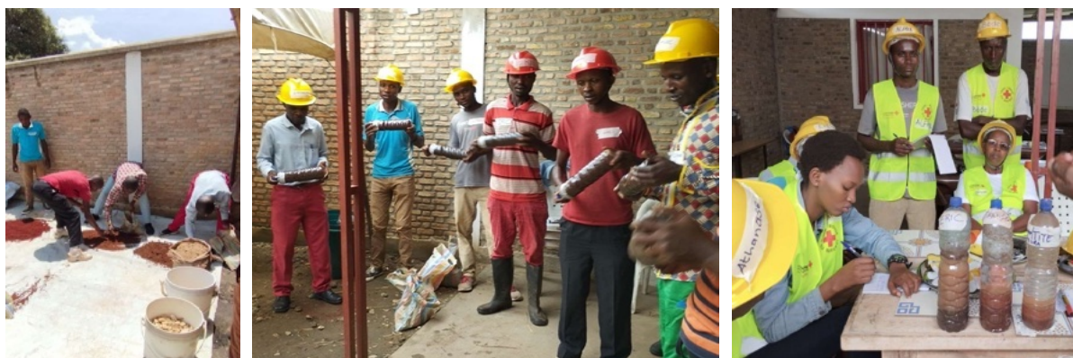
Test de la décantation : préparation, repos, résultats, fonction
