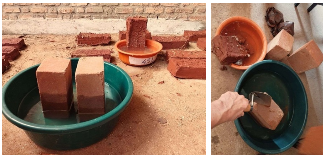
Essais de capillarité et de résistance post-trempage. Comparaison BTC – adobes produits lors de la formation
