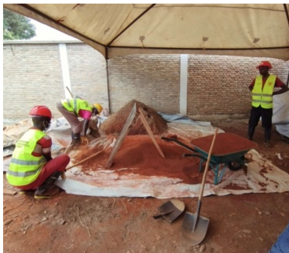
Arrivée de l'équipe de la RDC pour la formation complémentaire en BTC : tamisage, dosage, présentation et entretien de la presse Terstaram ; fabrication, manipulation, cure, séchage
