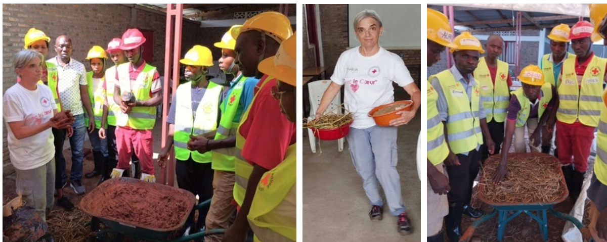
Adobe simple et fibré : préparation des mélanges. Comparaison des résistances. Moulage, séchage et stockage
