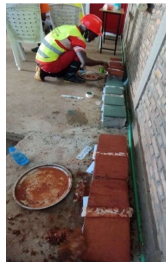
Test de la plaquette : stabilisation avec sable. Dosage. Étiquetage
