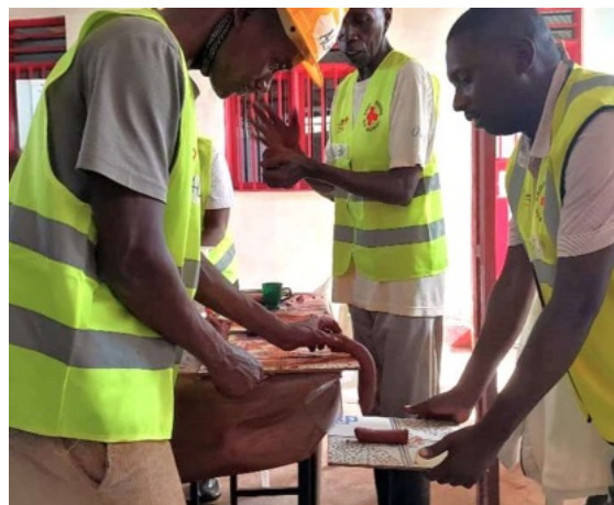
Test du cigare : tamisage de la terre, préparation et exécution. Résultats
