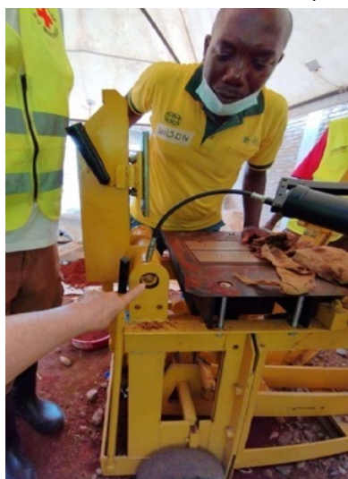
Arrivée de l'équipe de la RDC pour la formation complémentaire en BTC : tamisage, dosage, présentation et entretien de la presse Terstaram ; fabrication, manipulation, cure, séchage
