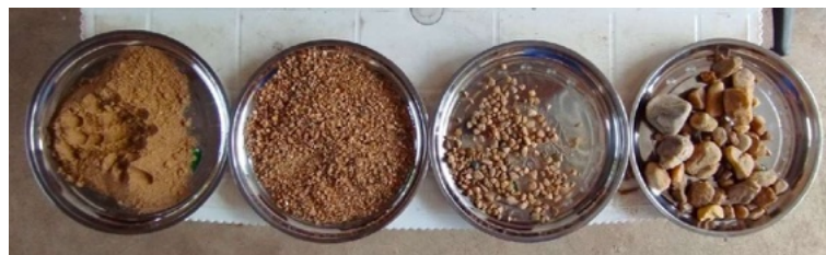
Granulométrie de la matière. Tamisage : procédure, enregistrement des résultats, étiquetage
