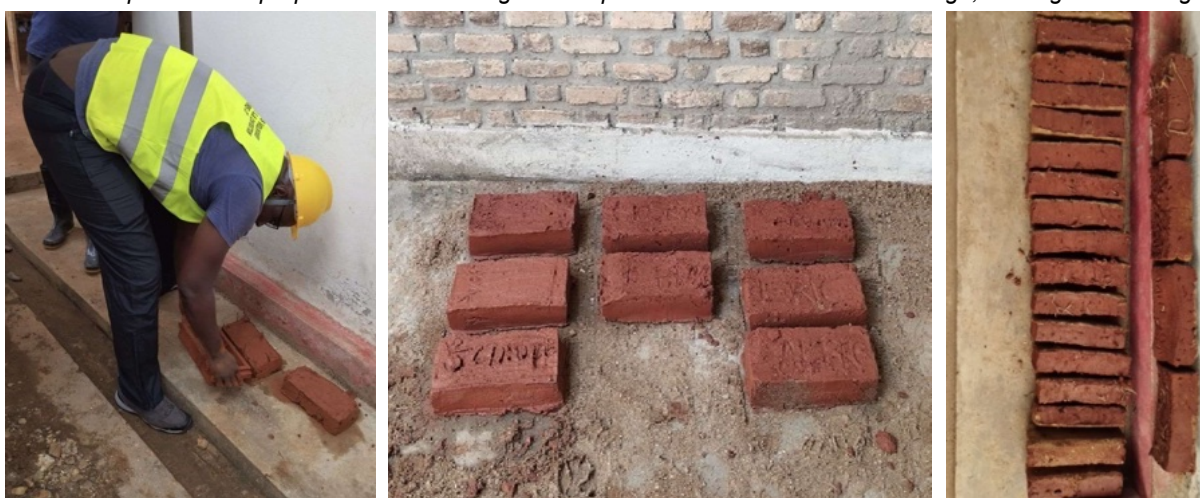
Adobe simple et fibré : préparation des mélanges. Comparaison des résistances. Moulage, séchage et stockage
