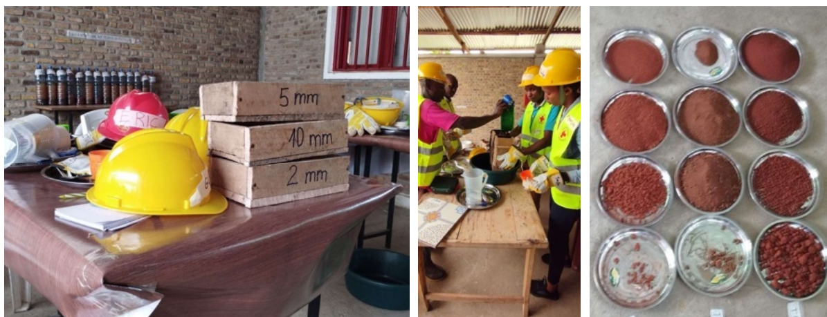
Granulométrie de la matière. Tamisage : procédure, enregistrement des résultats, étiquetage
