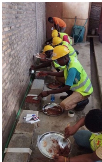
Test du cigare : tamisage de la terre, préparation et exécution. Résultats
