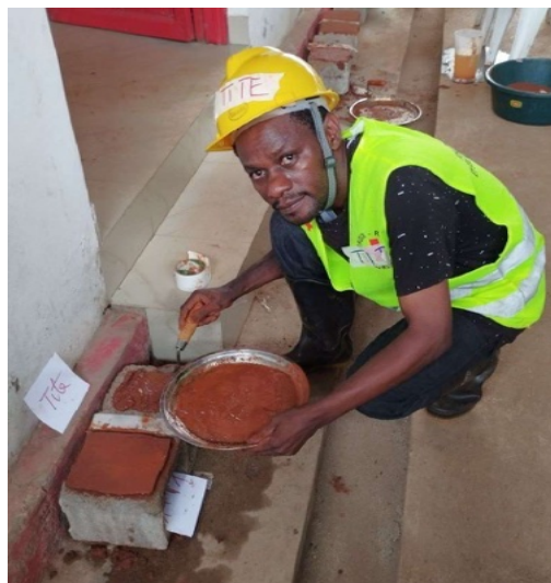
Test de la plaquette : stabilisation avec sable. Dosage. Étiquetage
