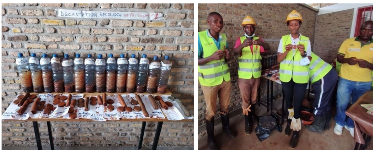
Résultats des tests de la décantation, du cigare et de la pastille
